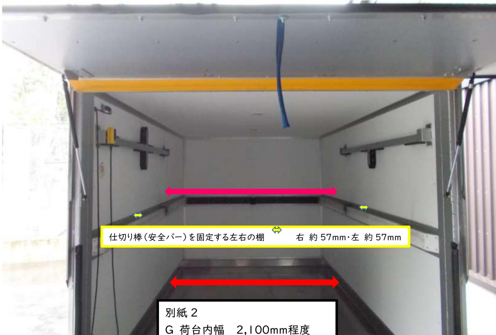
仕切り棒(安全バー)を固定する左右の棚 ⇄ 右 約 57mm・左 約 57mm
